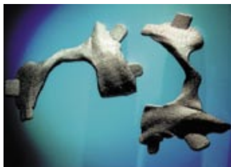
Herstellung eines Implantates (Jochbein) auf der Grundlage von CT-Daten mit Hilfe des Selective Laser Melting Verfahrens.
