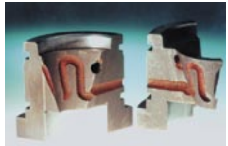
Herstellung von Serienwerkzeugen mit konturan- gepassten Kühlkanälen mit Hilfe des Selective Laser Melting.
