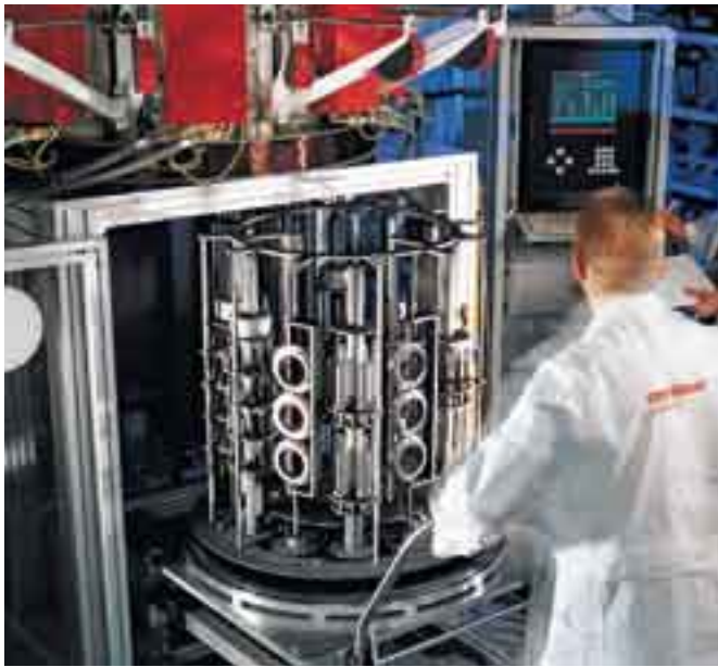
Vor der Beschichtung werden die Teile auf auswechselbaren Substrat-halterungen chargiert und in die Anlage eingefahren.
