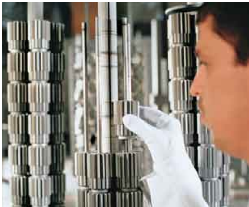
Die Plasmabeschichtung von Zahnrädern in einem Getriebe erhöht die Leistung des Motors und verlängert seine Lebensdauer. Fotos: Oerlikon Balzers
