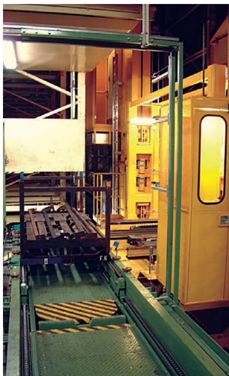
Die Aufgriffstation in der Lagervorzone ist mit Drehschubgabeln bestückt und in der Breite verstellbar.
