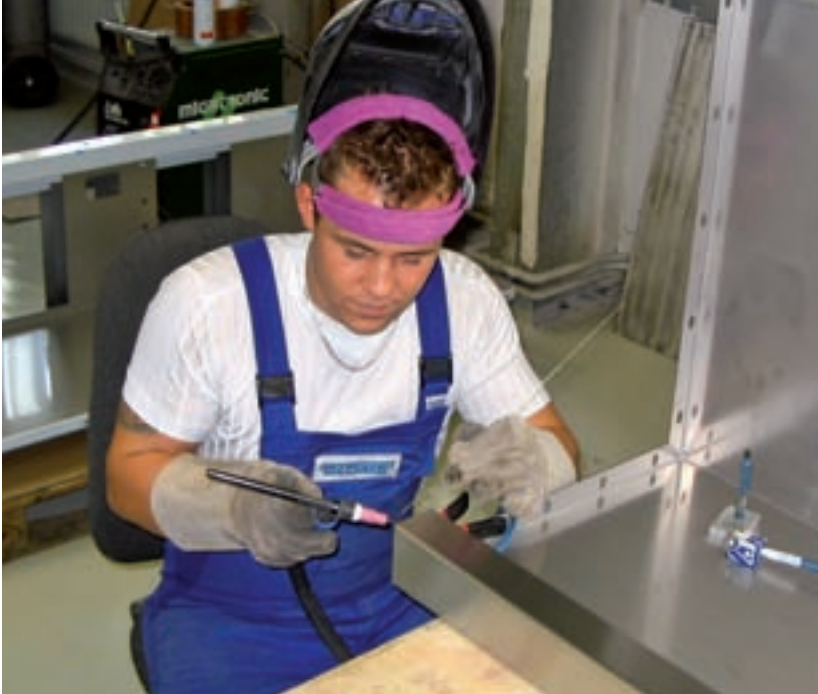
Die moderne Form der Ausbildung hat eigenverantwortlich handelnde Mitarbeiter zum Ziel. Unser Bild zeigt einen Auszubildenden als Konstruktionsmechaniker, der eine Blechkomponente für eine Kabine schweißt. Foto: Glomb
